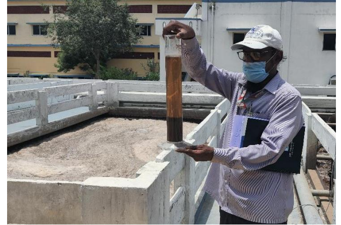
অ্যারেশন ট্যাংকের সেটলিং পর্যবেক্ষণ – অপারেটরের অন্যতম গুরুত্বপূর্ণ পর্যবেক্ষণ
